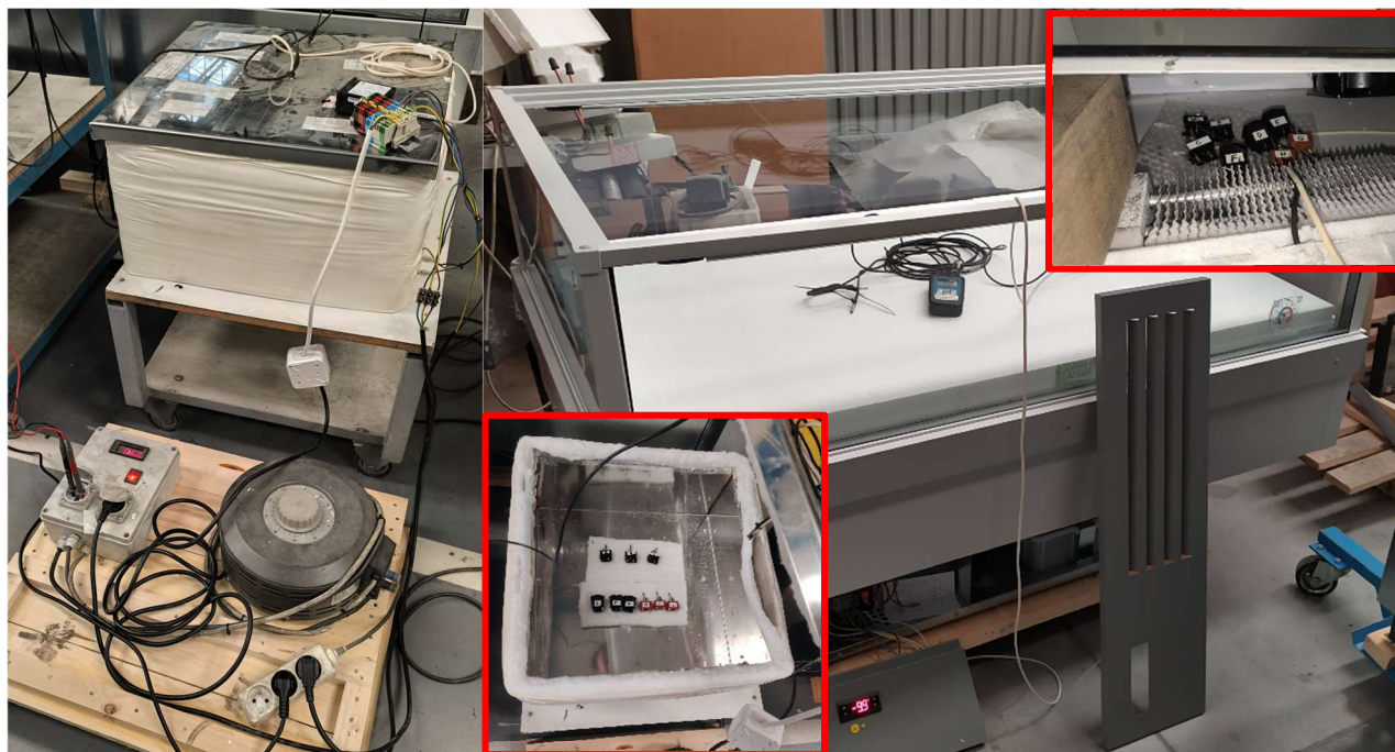
Obr. 4 Termostatický box (vľavo) a chladiaca vitrína (vpravo) pre kondicionovanie
