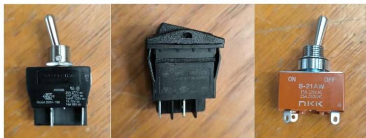
Obr. 3 Testované vzorky kolískových spínačov
